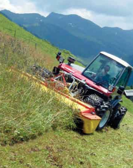
Kompakte Frontscheibenmäherwerke für Zweiachsmäher, Berg- und Normaltraktoren
